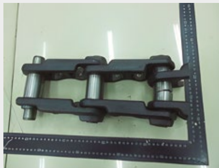
Con el pasador roto, los eslabones de la cadena de la oruga pueden soportar la tensión y no se deformarán.
